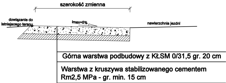
Przekrój konstrukcyjny (zjazdu z kruszywa)
